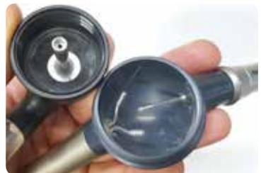
Beschädigte Pulverkammern durch scharfe Gegenstände - Verstopfungsgefahr.
