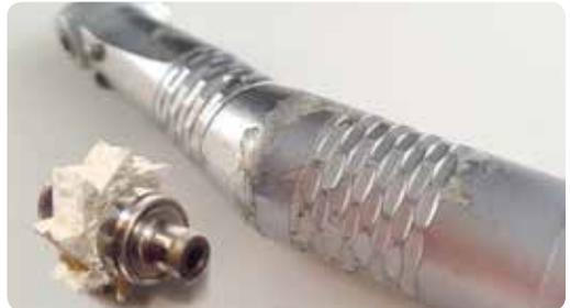
Turbinenläufer und Winkelstück durch Desinfektionsmittel zerstört.
