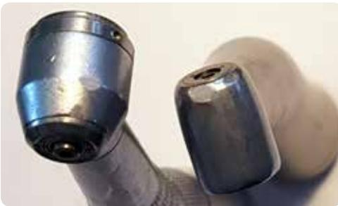
Turbinen- / Winkelstückkopf mit Fallschaden
