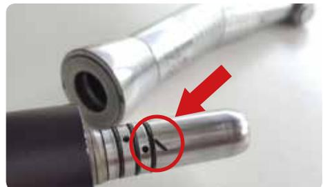
Fragmente von defekten O-Ringen können zu Verstopfungen der Medienkanäle der Instrumente führen.
