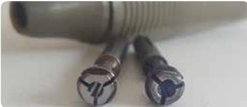
Neue Spannzange gegenüber verschlissener Spannzange.
