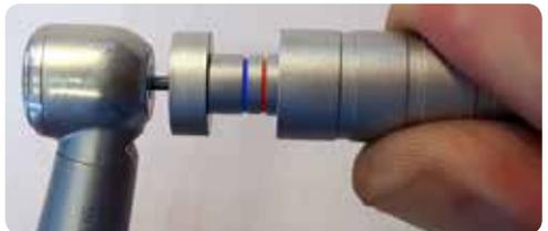
Haltekraftprüfung der Spannzange.
