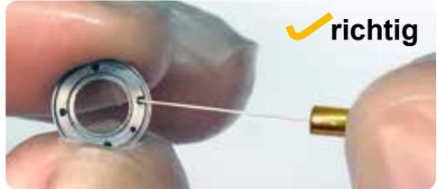
Richtige Reinigung der Spraydüsen von innen verhindert ein Deformieren der Sprayöffnungen.
