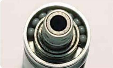
Kopftrieb mit defektem Keramikkugellager. Torlonkäfig ist durch Hitzeentwicklung geschmolzen.
