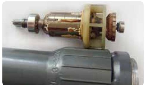
Handstück mit verbranntem Anker. Isolation ist geschmolzen.
