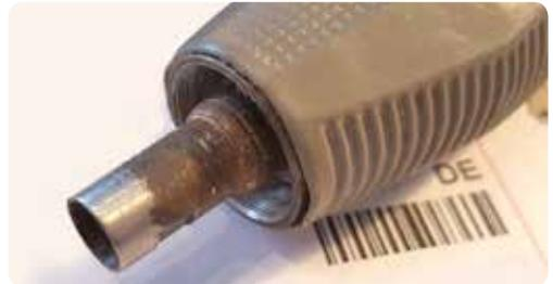
Rost auf der Handstück-Achse durch Feuchtigkeit.
