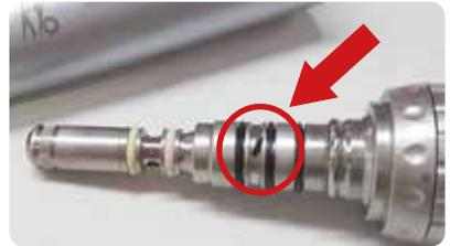
Fragmente von defekten O-Ringen können zu Verstopfungen der Medienkanäle der Instrumente führen.
