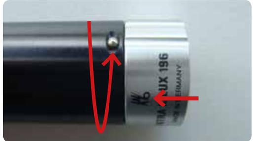
Geminderter Wasserdurchfluss durch Drehen der Wasserregulierung.
