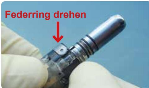
Federring soweit drehen, bis Lampe frei liegt.
