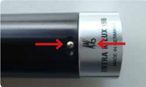
In dieser Position ist der maximale Wasserdurchfluss gegeben.
