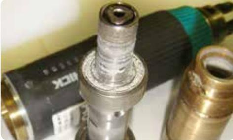
Durch Pressluft mit Gips blockiertes Kugellager.
