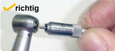
Mit passendem Schlüssel Spraydeckel öffnen.
