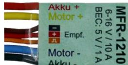
Der MFR-1210 ist geeignet für den Einsatz im Funktionsmodellbau, insbesondere für Neben- und Hilfsantriebe, aber auch für den kompletten Fahrtrieb kleiner Modelle.
