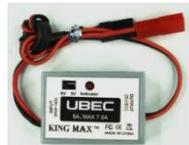
Der 6A UBEC kann an einem 2-7 Zellen Lithium-Akku angeschlossen werden. Der Switch-Mode-DC-DC-Regler gibt eine gleichmäßige, stabilisierte Leistung für Ihre Empfänger, Kreisel und Servos ab. Mit diesem BEC kann der Empfänger direkt von der Hauptbatterie mit Strom versorgt werden, so dass ein zusätzlicher Akku für den Empfänger nicht erforderlich ist.
